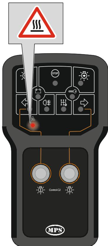
**FR** Dispose d'une protection contre la surchauffe. Le testeur est conçu pour tester des fonctions et non pour une utilisation continue. En cas d'utilisation continue, le testeur déconnecte la consommation électrique dès que celle-ci atteint 42°C.
