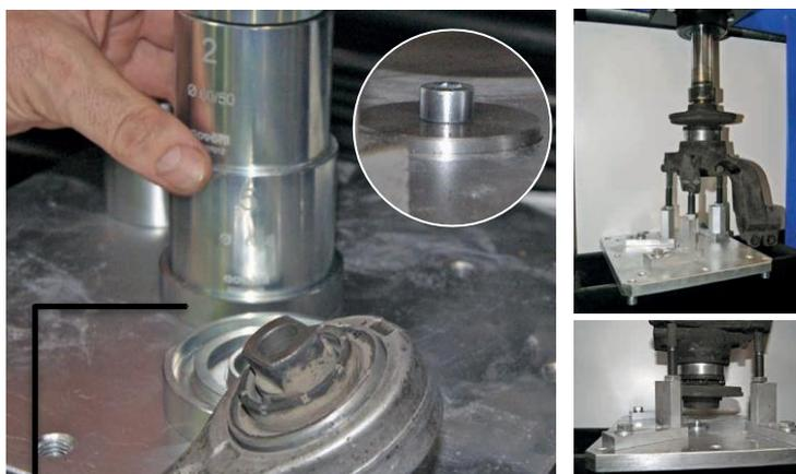
Le disque de centrage inclus vous permet de loger les douilles nécessaires pour retirer/insérer le silentbloc
